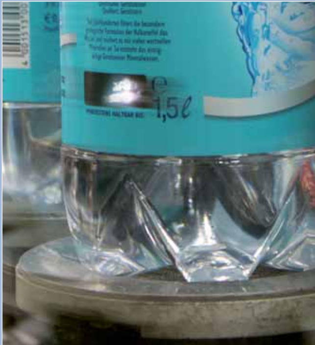
Der Laserstrahl verändert die Oberfläche des Produktes thermisch: Es wird ein Bruchteil weg gebrannt.
