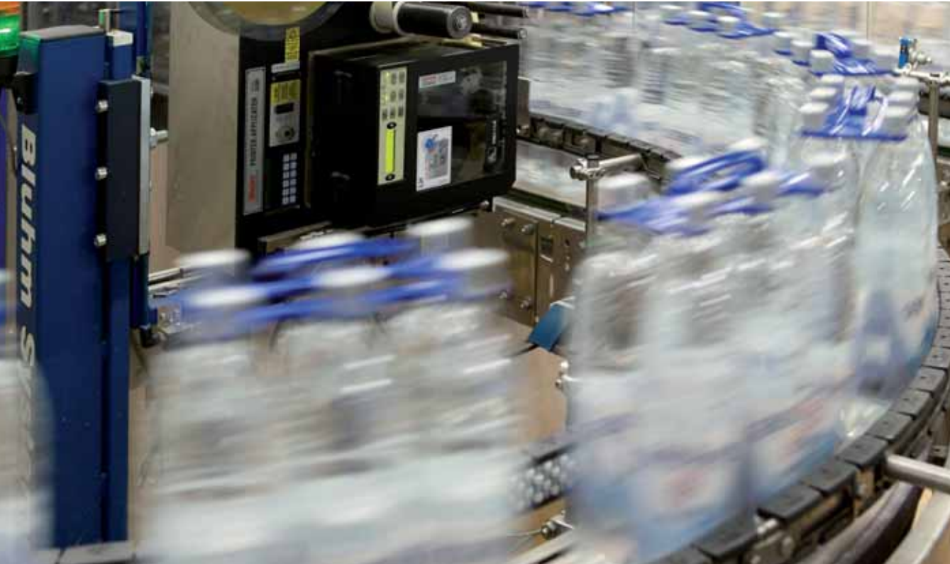
Bis zu 50 Barcode-Etiketten pro Minute bringt der Legi-Air berührungslos seitlich auf die Six-Packs auf.
