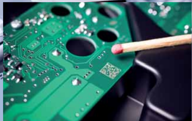
Der 6 x 6 mm große DataMatrixcode beinhaltet Informationen wie Seriennummer, eine fortlaufende Nummer, Datum und Uhrzeit.
